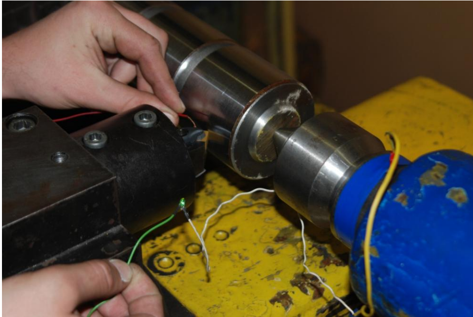
Рисунок 3.7 - Настройка на заданный технологический натяг.
