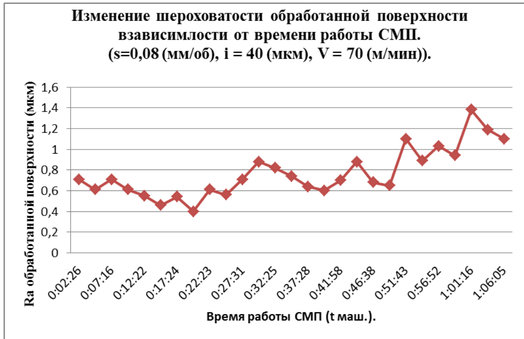
Рисунок 4.23 – Зависимость шероховатости выглаженной поверхности от времени работы СМП.
