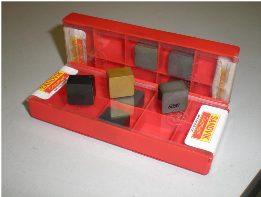
Рисунок 3.2 - Токарные пластины, использованные при обработке выглаживанием.
