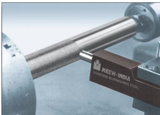
Рисунок 1.2 – Обработка выглаживанием наружной цилиндрической поверхности заготовки на токарном станке [90].
