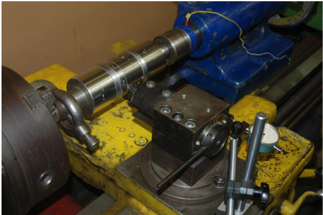
Рисунок 3.5 - Фотография технологического приспособления на станке в процессе обработки.
