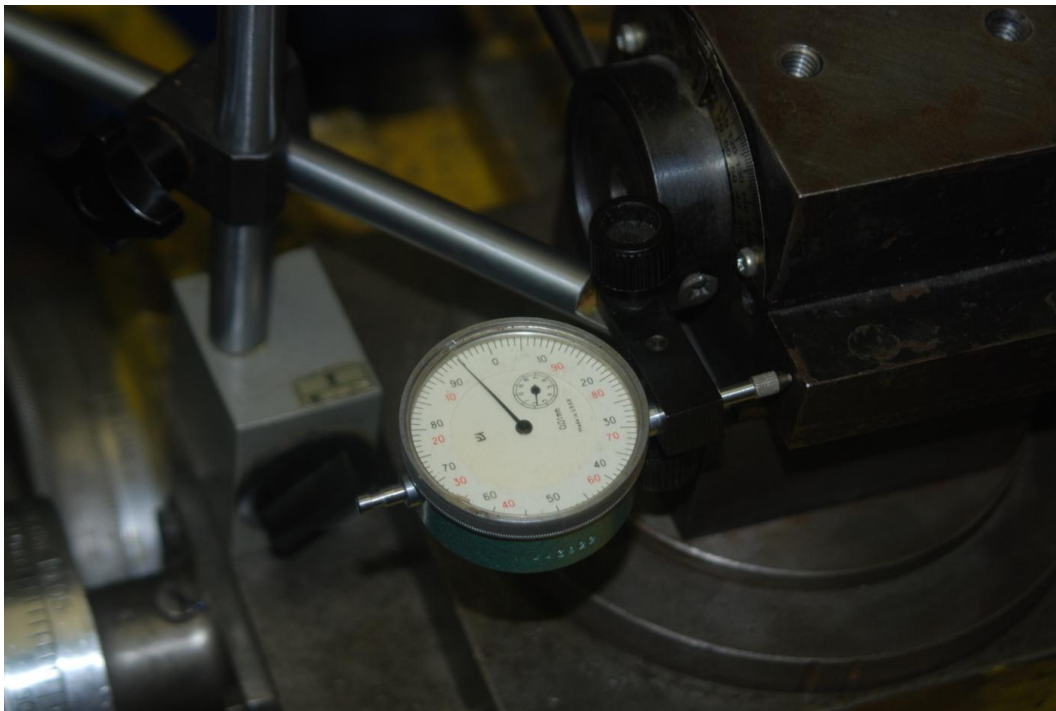
Рисунок 3.8 - Установка индикатора перемещений, для настройки на заданный натяг.
