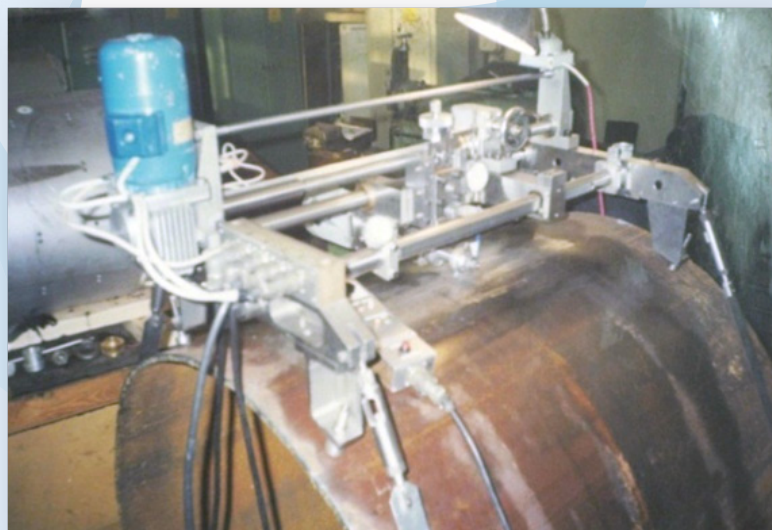
Установка для нанесения пазов-имитаторов на наружной поверхности трубы
