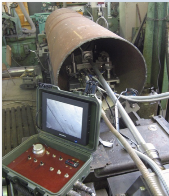
Установка для нанесения пазов-имитаторов на внутренней поверхности трубы
