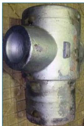
Корпуса запорной и регулирующей арматуры из стали 10Х9МФБ-Ш
