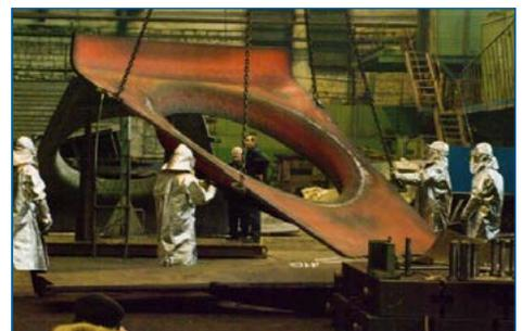
*Штамповка заготовок секторов крыши корпуса реактора БН-800*
