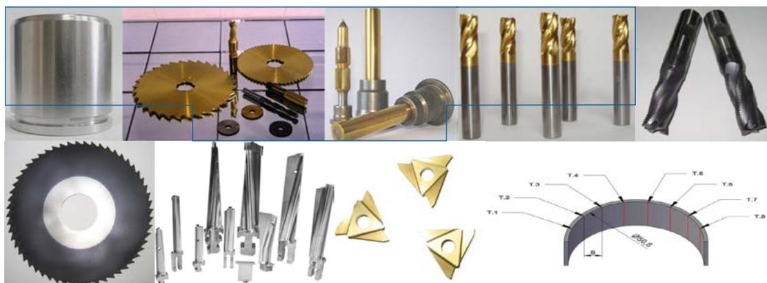
ной отраслях. Высокотвердые покрытия предназначены для защиты тяжело нагруженных деталей машин, работающих в условиях интенсивного износа и циклически изменяющихся нагрузок, высоких температур и агрессивных сред (запорно-регулирующая арматура, пресс-формы для штамповки, лопатки авиационных и паровых турбин) и режущий инструмент (фрезы, сверла, зуборезный и обкаточный инструмент) (рисунок 2).
