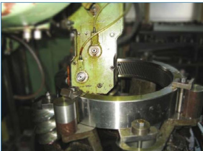
*Обработка зубчатого венца  $\varnothing$  1000 мм
