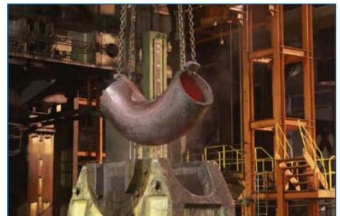
*Штамповка бесшовных колен главного циркуляционного трубопровода Ду850 с угломгиба 90°*
