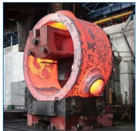
*Штамповка патрубков Ду850 на патрубковых обечайках корпусов реакторов АЭС-2006 и ВВЭР-ТОИ*
